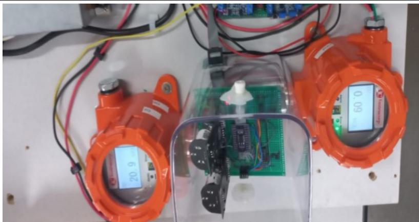
Parte da bancada de calibração mostrando o receptáculo com as células de gases e os medidores com as leituras do gás padrão de CO<sub>2</sub> e O<sub>2</sub>
