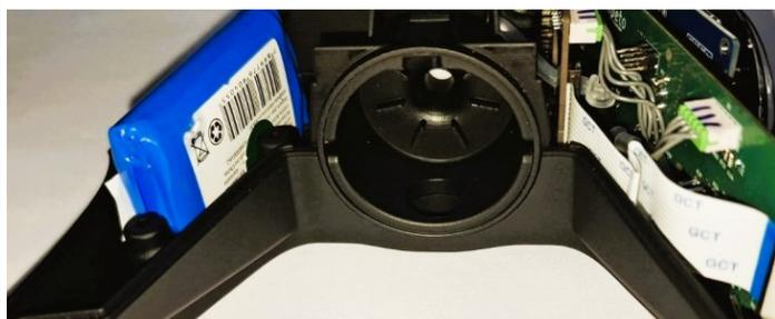
Foto da Vista Frontal mostrando as conexões internas e os aspectos aerodinâmicos para otimização nas leituras dos sensores.
