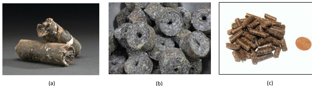
Figura 17. Intensificação do lixo derivado do resíduo por briquetes (a) - (b) ou pellets (c)
