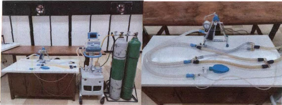
*Fig2. Circuito pulmonar bifurcações, montado no ventilador hospitalar.*
