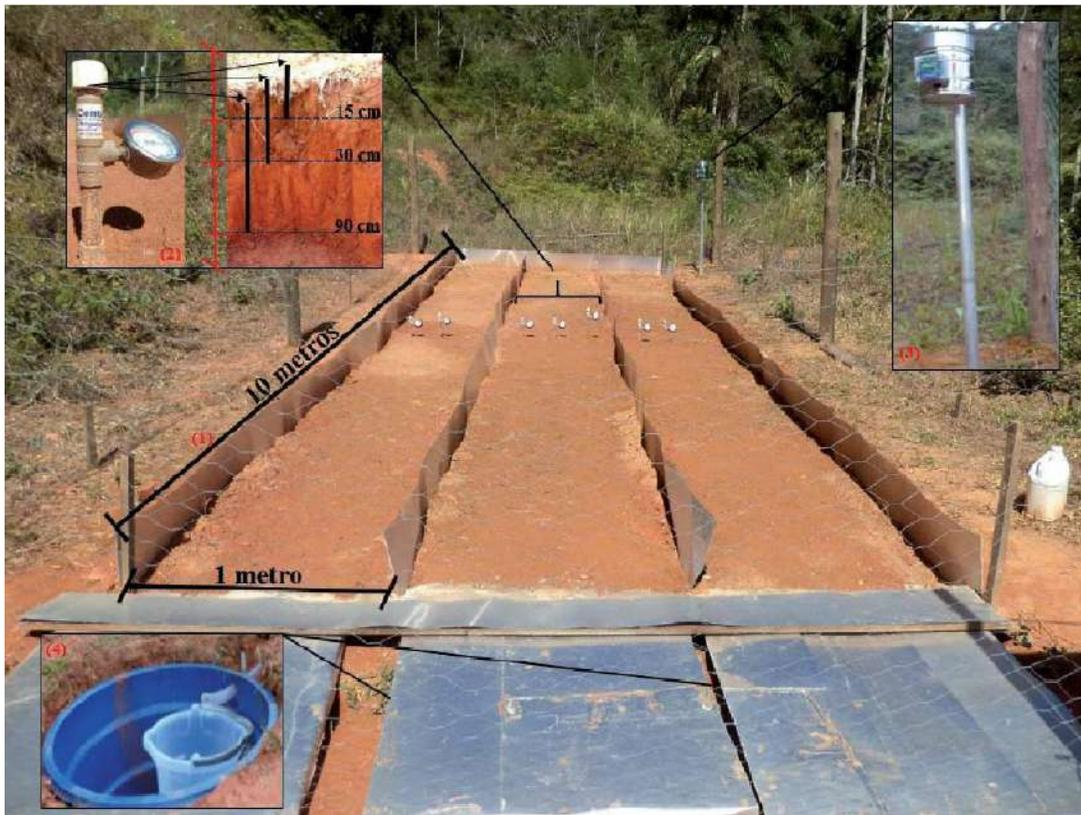
**Figura 8.** Representação esquemática da parcela de monitoramento de perda de solo por erosão hídrica. Adaptado de Pereira et al (2016).
