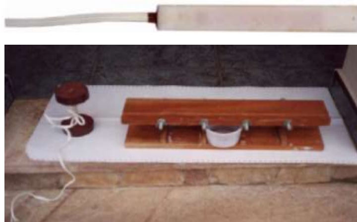
Figura 4 – Exemplo de strain gage para imersão em concreto (revestimento acrílico), incorporado a molde em resina acrílica. Solução aplicada por Fernandes (2005) em pavimento ferroviário.
