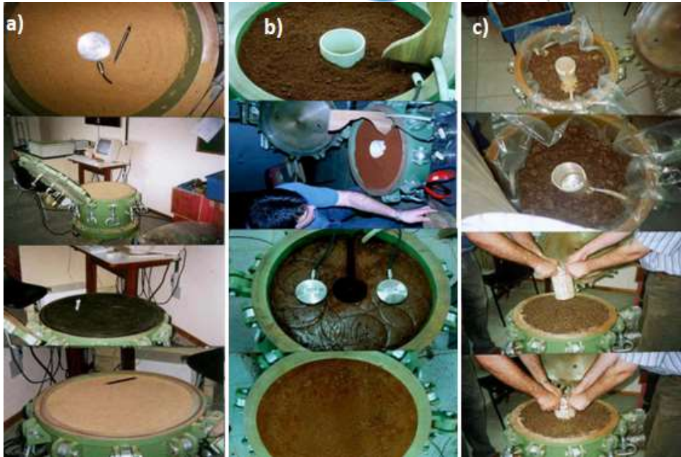
Figura 12 – Detalhes do ensaio de calibração das células de tensão total (Gonçalves, 2002).
