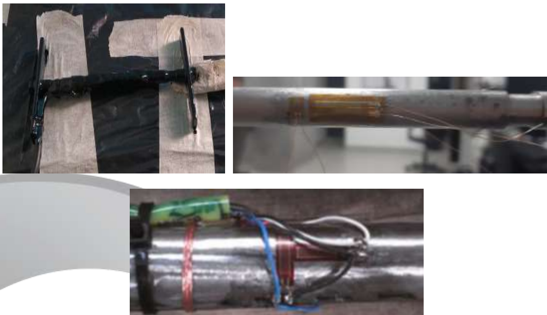
Figura 5 – Exemplo de elemento instrumentado com strain gages (Silva et al. , 2019). A técnica é baseada na instrumentação de barras de aço com strain gages montado em ponte completa (Silva e Ehrlich, 2010).
