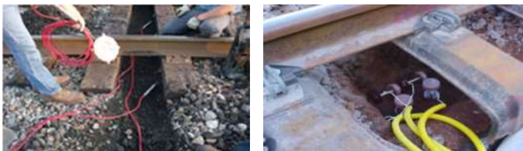
Figura 19 – Células de tensão total (Rose et al. , 2018). Elementos instrumentados com strain gages (Fernandes, 2005).
