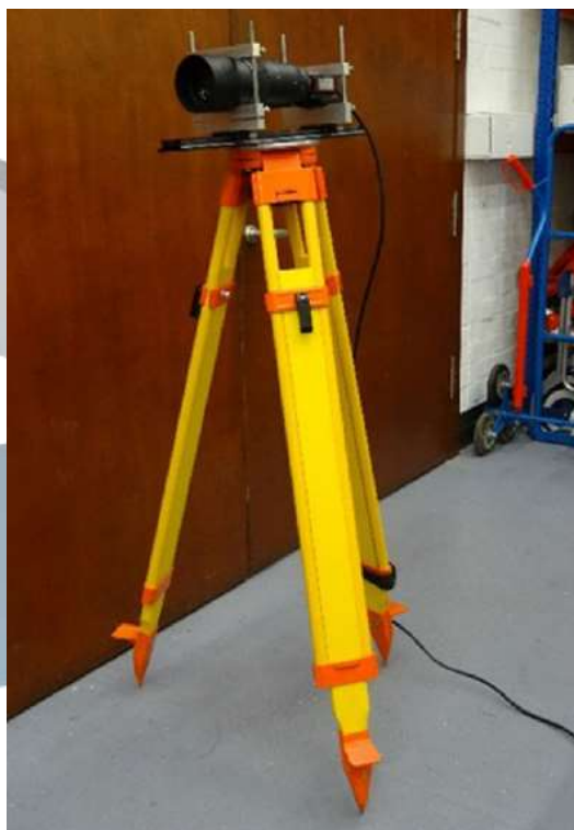
Figura 9 – Exemplo de montagem do sistema de filmagem, com tripé topográfico e conjunto de câmera e lente (Brownjohn et al. , 2017).
